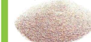
この焼却炉は流動床式と言って、角型の炉で出来ていて、下部に流動砂がいっぱい入っています。この砂を重油バーナーで600℃の高温に熱し、更に底部（砂の下）の散気管から熱風によって砂が流動状態に動きます。砂が動く事によって、ごみの分散、乾燥、過熱、燃焼が効率よく行われ瞬時に焼却されます。
